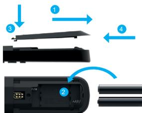
Der Fernbedienung liegen zwei Batterien des Typs AAA (LR03) bei. Bitte setzen Sie diese gemäss Beschriftung mit der korrekten Plus- und Minuspolung ein.
